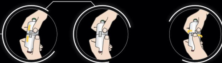
**SCHRITT 2** Richten Sie die Verbindungsenden der beiden Flaschen so aus, bis diese einrasten. Als Orientierung dienen die silberfarbenen Plastikflaschen. Drücken Sie nun die Flaschen fest zusammen, bis sie sich vollständig berühren. Ein Klick bestätigt, dass die Flaschen eingerastet sind.
